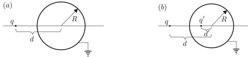
1. ábra. (a) A q ponttöltés egy földelt fémgömb közelében. (b) A gömbön létrejövő töltés terét megfeleltethetjük a q' tükörtlöltés elektromos terének
